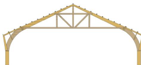
Structure mise à nue avant renforcement et principe de renforcement des arcs en bois lamellé-collé
